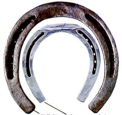
極軟鋼 アルミニウム合金 巾19.8 mm 巾10 mm 厚 9.9 mm 厚 6 mm 重 950g 重 75g
